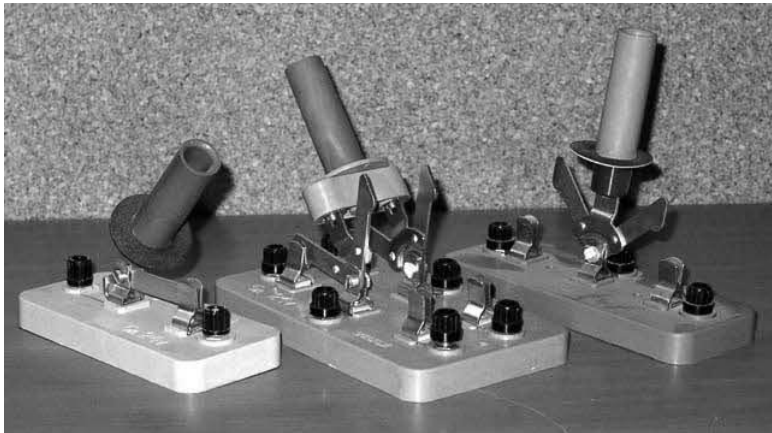
Рис. 4.25. Выключатели и переключатели демонстрационные
