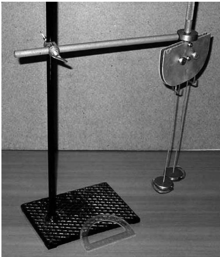
Рис. 4.91. Прибор для изучения движения тела по окружности
