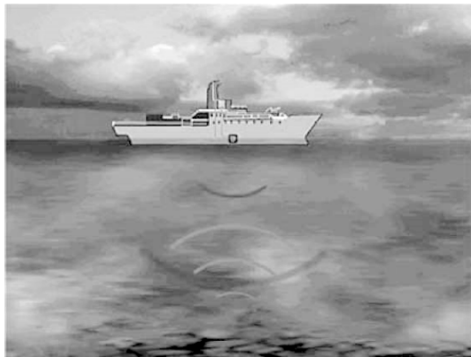
Рис. 10. Принцип работы эхолота
