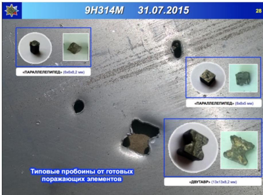
Пробоины от взрыва боеголовки ракеты 9М38М1 в дюралевом щите (эксперимент концерна «Алмаз-Антей»). Внизу – «бабочка». Источник: ТАСС/Эксперимент «Алмаз-Антей».
