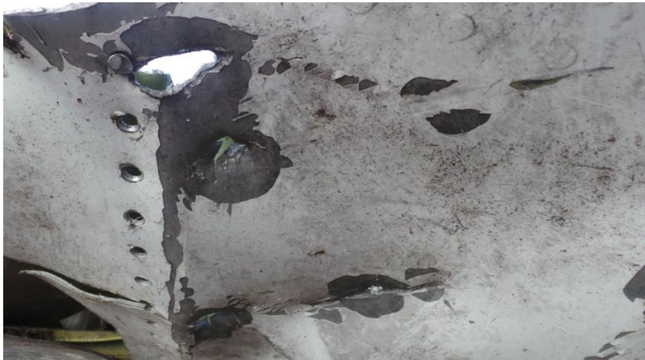
Эллипсообразная пробоина в крыше кабины пилотов (правая сторона). Диаметр шляпки заклепки – 8 мм, калибр боеприпаса – 12,7 мм. Фото Jeroen Akkermans.
