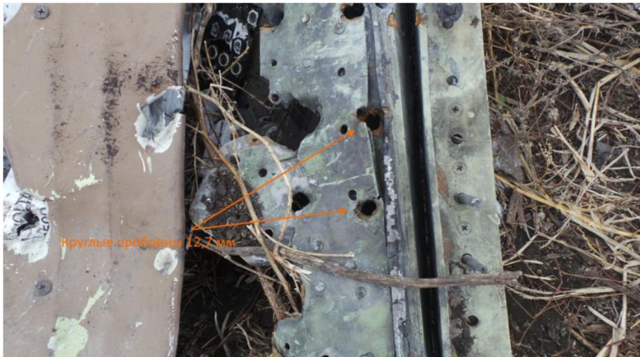
Круглые пробоины в раме кабины пилотов. Фото Јероен Аккерманс (нанесена разметка).
