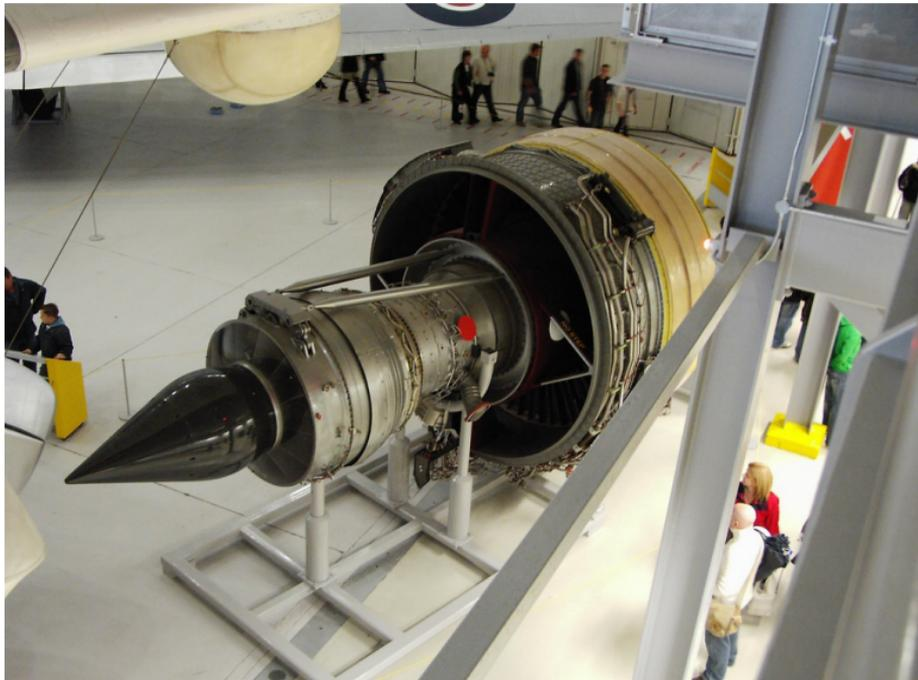
Двигатель Trent 800 без кожуха. Фото Nigel Renny.
