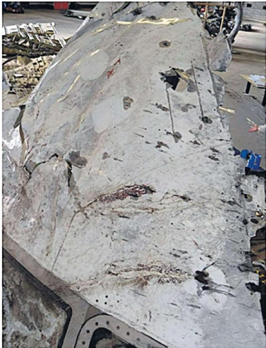
Крыша кабины пилотов (правая сторона). Направление движения поражающих элементов зенитной ракеты и стрелкового боеприпаса примерно одинаковы. Источник DSB.
