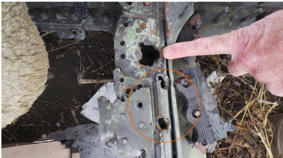
Круглые пробоины в раме кабины пилотов. Толщина указательного пальца – около 18 мм, калибр боеприпаса – 12,7 мм. Фото Jeroen Akkermans (нанесена разметка).
