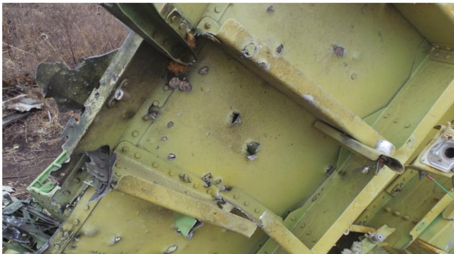
Пробоины различной формы и размеров (вид изнутри).
