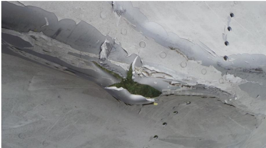
Разрыв обшивки, вызванный ударом изнутри. Фото Jeroen Akkermans.
