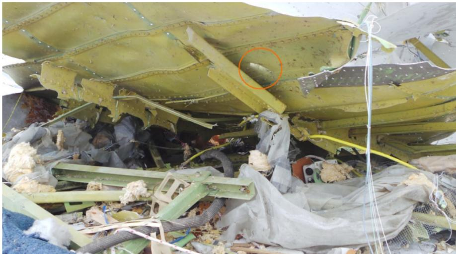
Пробоина в обшивке лайнера, вызванная внутренним взрывом. Фото Jeroen Akkermans (нанесена разметка).
