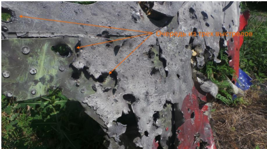
Стрелковые пробоины и повреждения обшивки с левой стороны кабины пилотов. Фото Jeroen Akkermans (нанесена разметка).
