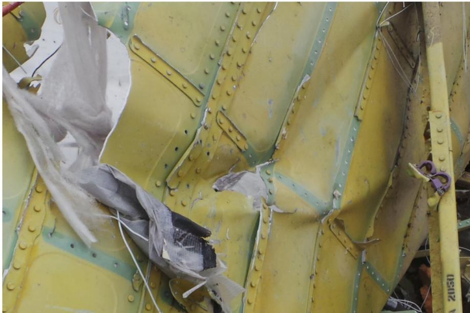
Пробоина в обшивке лайнера, вызванная внутренним взрывом. Фото Jeroen Akkermans.
