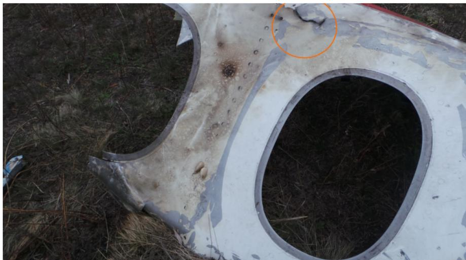
Пробоина в обшивке лайнера, вызванная внутренним взрывом и следы от внутреннего пожара. Фото Jeroen Akkermans (нанесена разметка).
