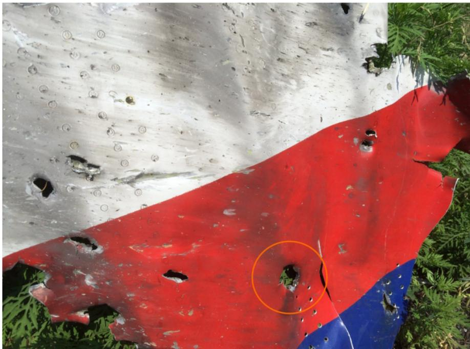
Круглая пробоина от 30 мм стрелкового боеприпаса в обшивке кабины пилотов. Фото Jeroen Akkermans (нанесена разметка).
