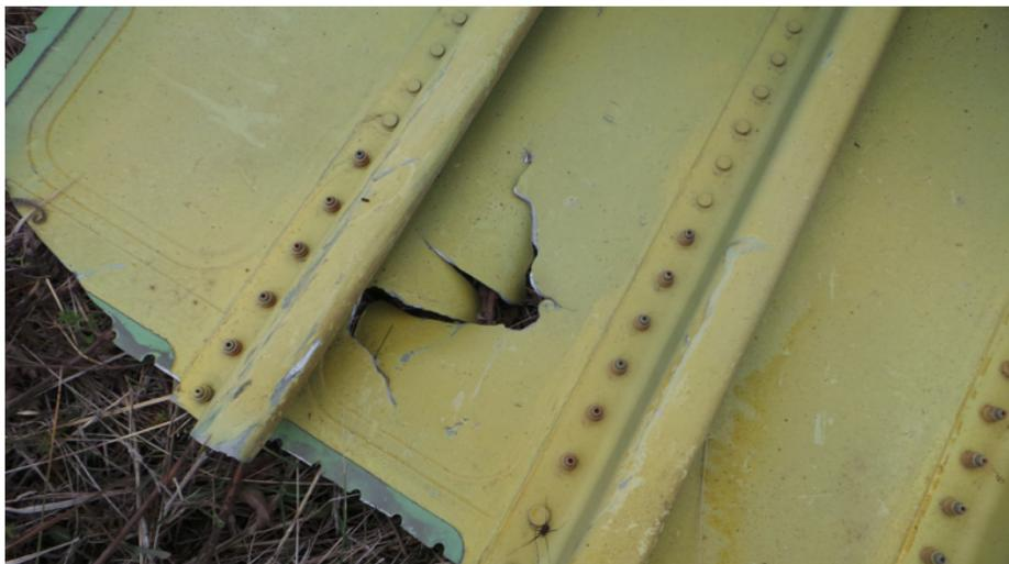
Пробоина в обшивке лайнера, вызванная внутренним взрывом. Фото Jeroen Akkermans.
