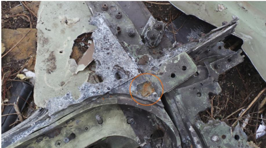
След от непробития рамы поражающим элементом зенитной управляемой ракеты с габаритами 18×18. Фото Јероен Akkermans.
