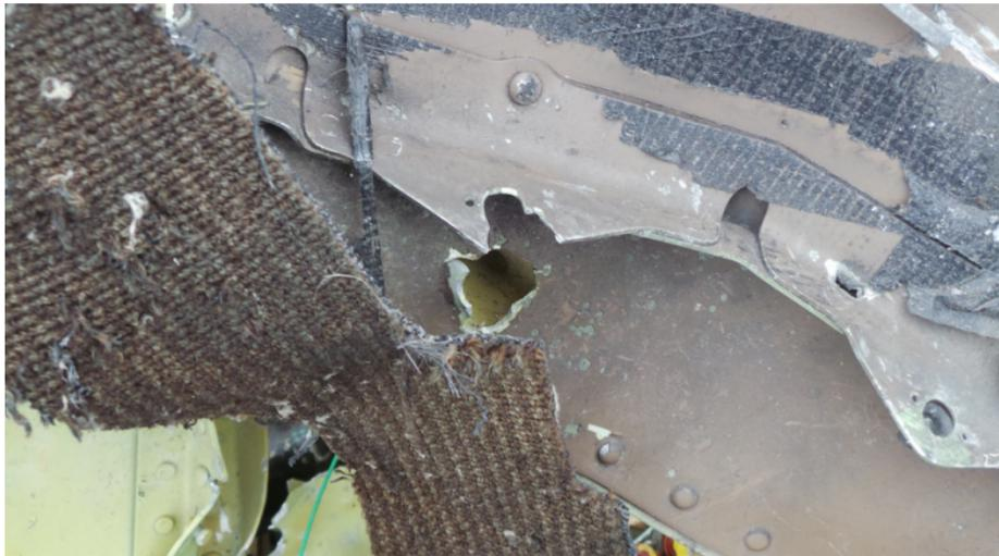
Пробоина в полу кабины пилотов, вызванная внутренним взрывом. Фото Jeroen Akkermans.
