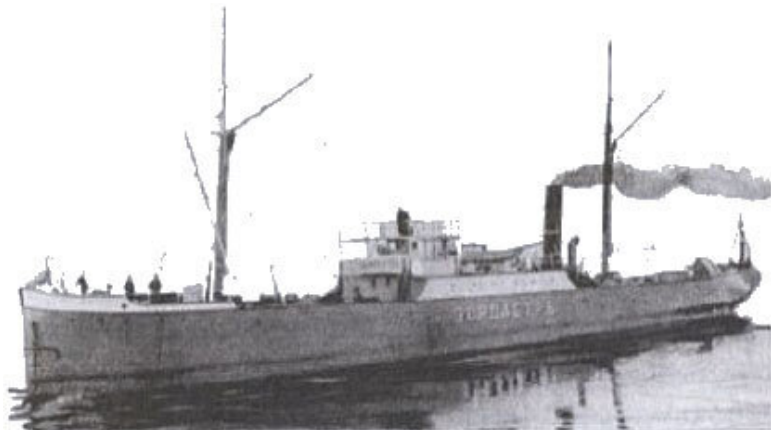
Нефтеналивной пароход «Зороастр», изготовленный по заказу Л. Нобеля на заводе «Мотала» в Швеции. 1877–78 гг.
