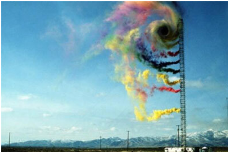
Рис. 3.4.38. Краски для изучения воздушных потоков
