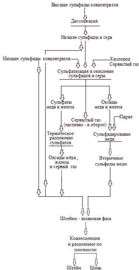
Рис. 1.37 Технологическая схема окисления в медеплавильном производстве
