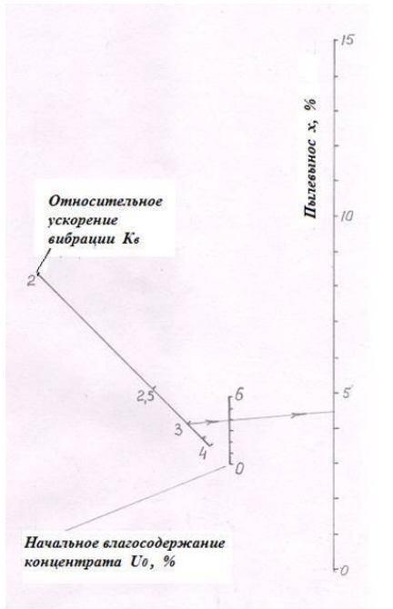
Рис.1.28 Номограмма для определения пылевинаса из слоя флотационного концентрата в вибровакuumной установке при оптимальных параметрах: P = 5300 Па, f = 24 Гц, H_0 = 0,04 м, t_{op} = 450 С, \Delta t = 20^\circ\text{C}
